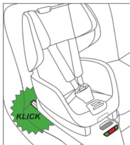
Setzen Sie nun die Optiafix an den ISOFIX-Bügel an und lassen Sie die Konnektoren hörbar einrasten.
